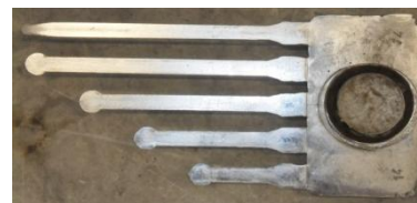
Отливки «Арфа» сплава системы Al-Ni-Mn-Fe с разным содержанием Si
