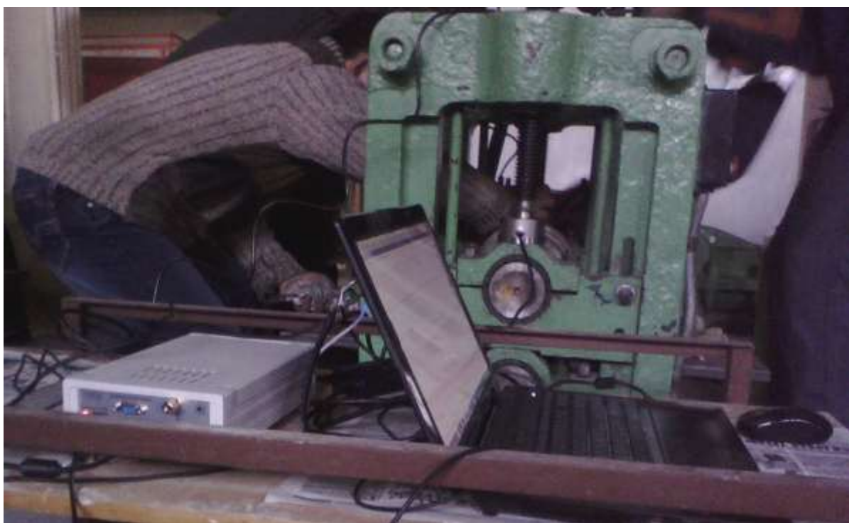
Рисунок А.2 – Подготовки тензометрической станции к измерению усилий прокатки
