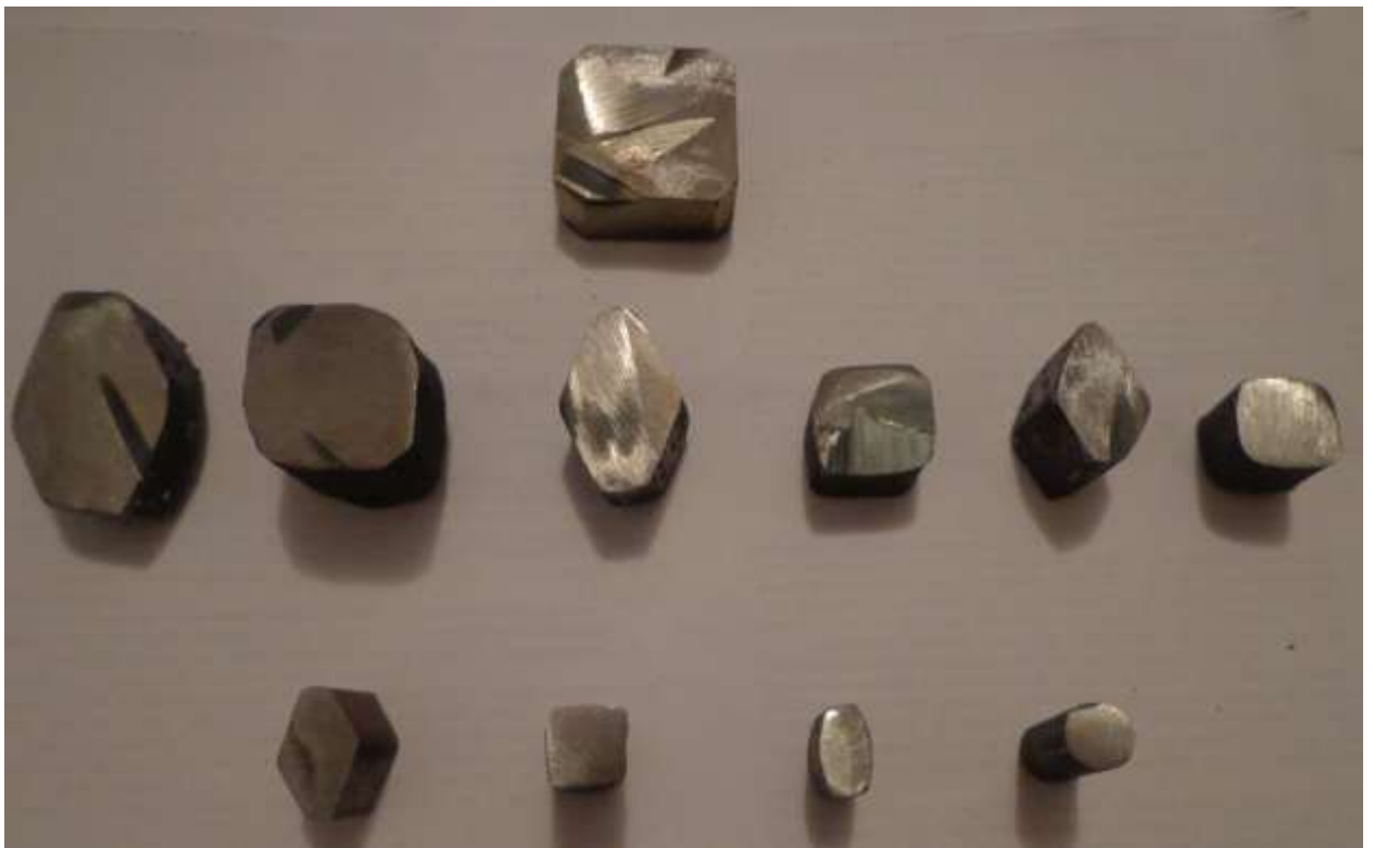
Рисунок А.4 – Темплеты профилей, полученных из соответствующих калибров по ходу прокатки по новой технологии
