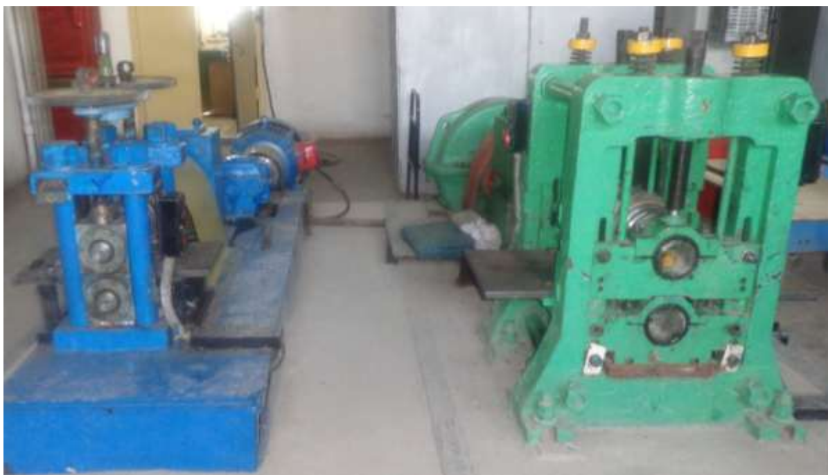
Рисунок А.1 – Экспериментальный полупромышленный прокатный стан «Дуо-200/150»
