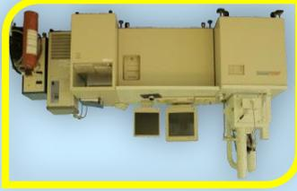
Сканирующий (растровый) электронный микроскоп предназначен для изучения топографии поверхности. Можно изучать и получать снимки объемных изображений и конфигураций структуры. Увеличение микроскопа составляет от 18 до 300 тысяч крат.
