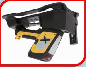
Портативный XRF анализатор предназначен для идентификации и анализа содержания химических элементов твердых и порошкообразных образцах металлов, сталей и сплавов, почв, руд и других веществ. Позволяет определять следующие элементы: Cd, Ti, V, Cr, Mn, Fe, Co, Ni, Cu, Zn, W, Hf, Ta, Re, Pb, Bi, Zr, Nb, Mo, Pd, Ag, Sn, Sb, Mg, Al, Si, P, S.
