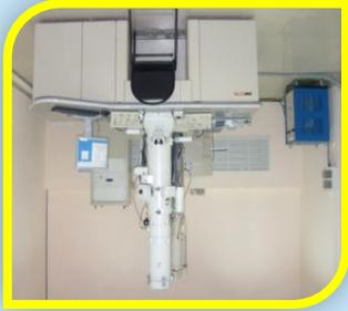
Микроскоп предназначен для изучения атомно-кристаллической структуры материалов, включая морфологию и характеристики кристаллической структуры, характеристики типа и распределения разных дефектов кристаллического строения. Увеличение микроскопа от 50 до 150000 крат. Разрешение до 2 Ангстрем.
