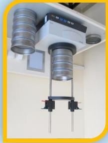
Размеры сит (мм) 500, 250, 125, 63, 45, 4, 2, 1. Управляемый электронный привод гарантирует оптимальную адаптацию к каждому распределению фракции с узким распределением по размерам частиц могут быть получены даже при очень коротких временах рассева.
