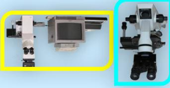
Предназначены для исследования фазового состава и структурных особенностей металлов и сплавов при увеличении до x 1000 раз (от x 100). LEICA DM IRM HC оснащен приставкой для определения микротвердости отдельных фаз, приставкой для автоматической микрофотоосъемки микроструктуры.
