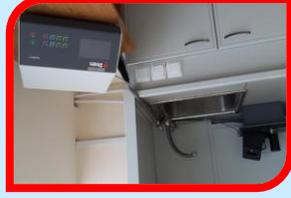
Устройство для автоматического электронного утонения образцов, предназначенных для электронного микроскопии SEM.
