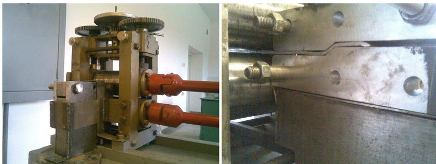
а – общий вид лабораторного оборудования; б – заготовка в процессе деформирования.
